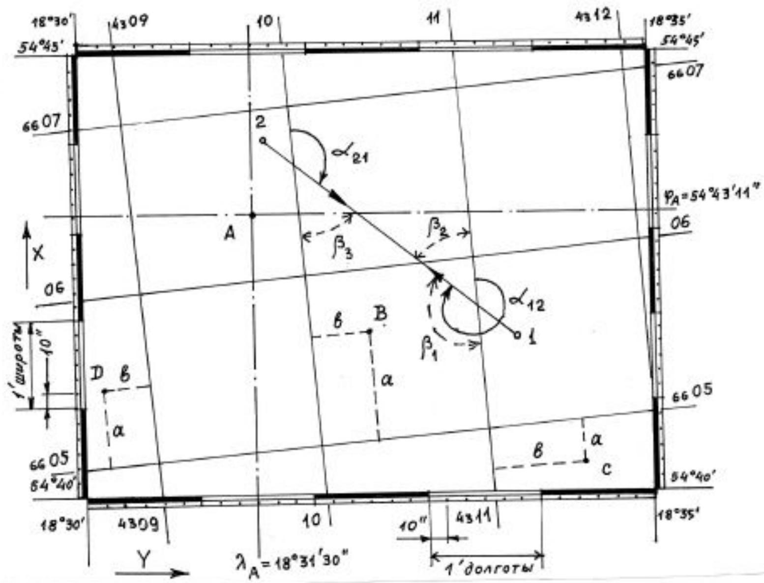
Для определения географических координат точки А необходимо воспользоваться линейкой, длина которой перекрывает поле карты. Ребро линейки должно проходить через точку А и через одинаковые отсчёты долготы на северной и южной рамке, либо через одинаковые отсчёты широты на западной и восточной рамке
