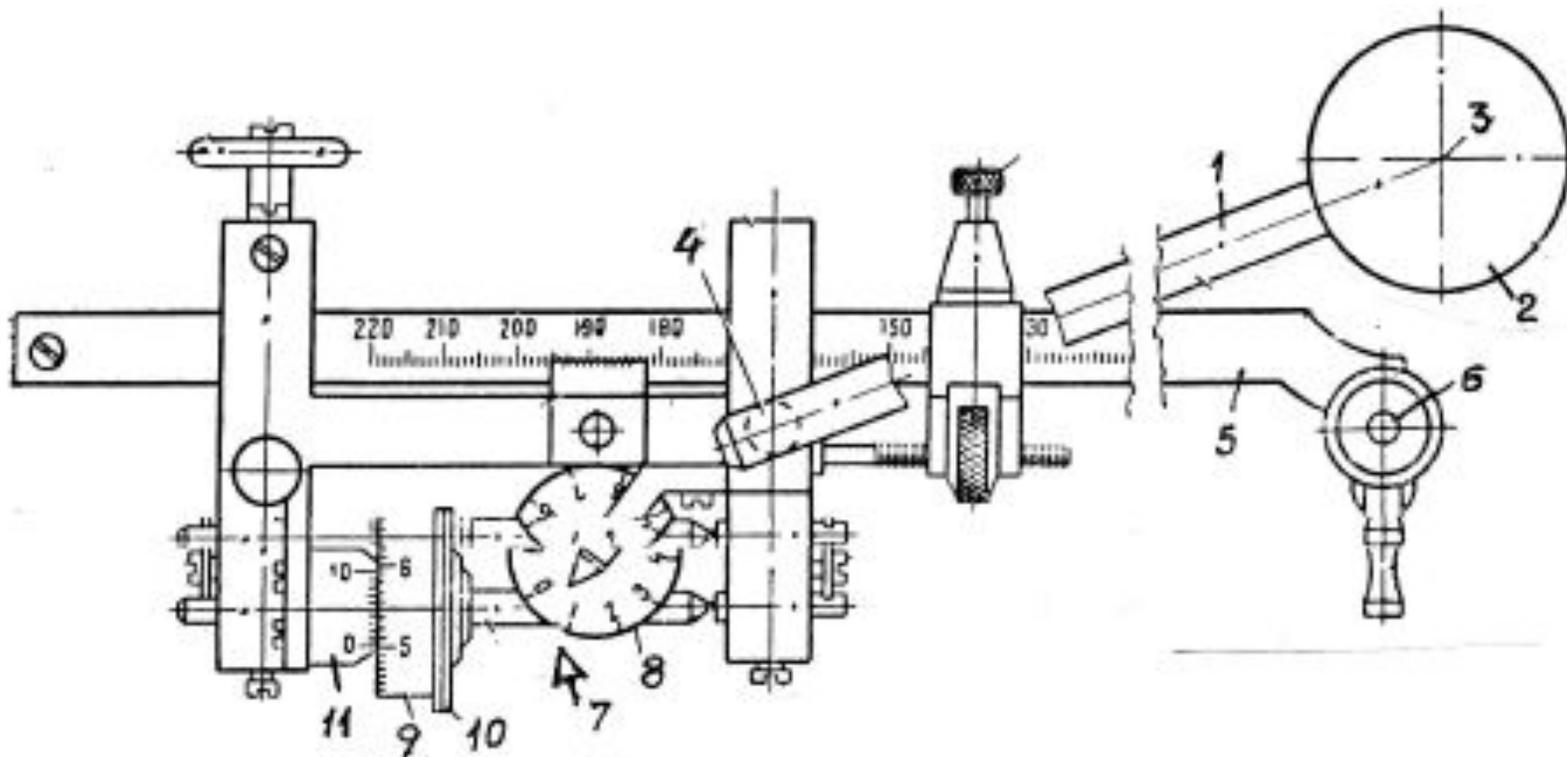
1- полюсный рычаг; 2 – грузик; 3 – игла; 4 – гнездо; 5 – обводной рычаг; 6 – обводной штырь (обводная марка); 7 – счетный механизм; 8 – дисковая шкала; 9 – счетное колесо; 10 – ободок счетного колеса; 11 – нониус.
