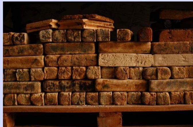
**СПЕКАЕМОСТЬ ГЛИН** - свойство глин уплотняться при обжиге с образованием камнеподобного черепка.
