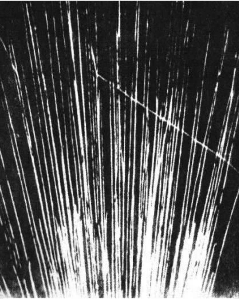
Рис. 28. Первое искусственное превращение элементов — взаимодействие \alpha -частицы с ядром азота, в результате которого образовались ядро кислорода и протон.
