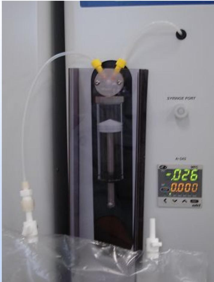
**Ввод пробы производится автоматически с помощью шприцевого насоса, что исключает потери при определении низких концентраций серы**
