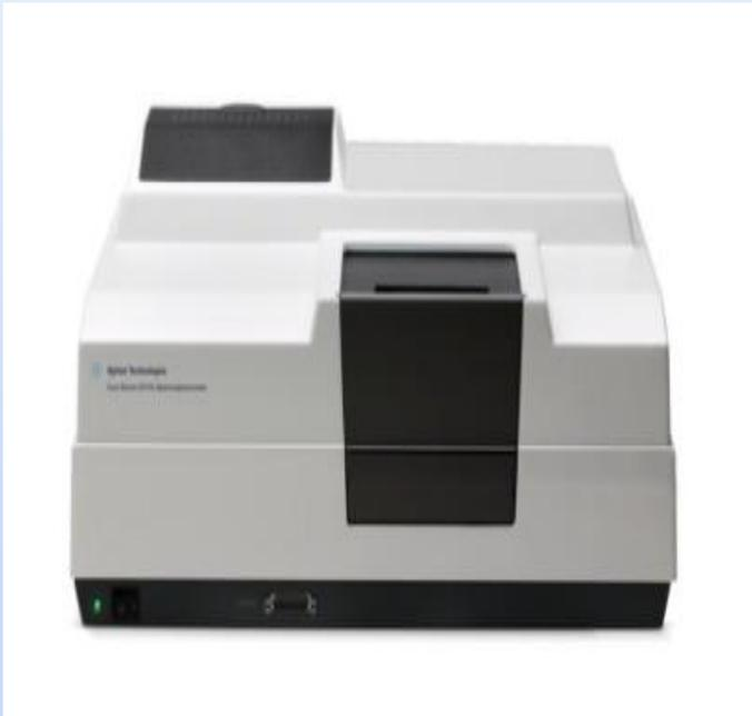
Прибор имеет двухлучевую схему с использованием оптических элементов с кварцевым покрытием, фиксированную  $<1,5$  нм/программируемую ширину спектральной щели от 0.2 до 4 нм (с разрешением до 0.2 нм) и обеспечивает линейный фотометрический диапазон до 3,0/3,5 А.
