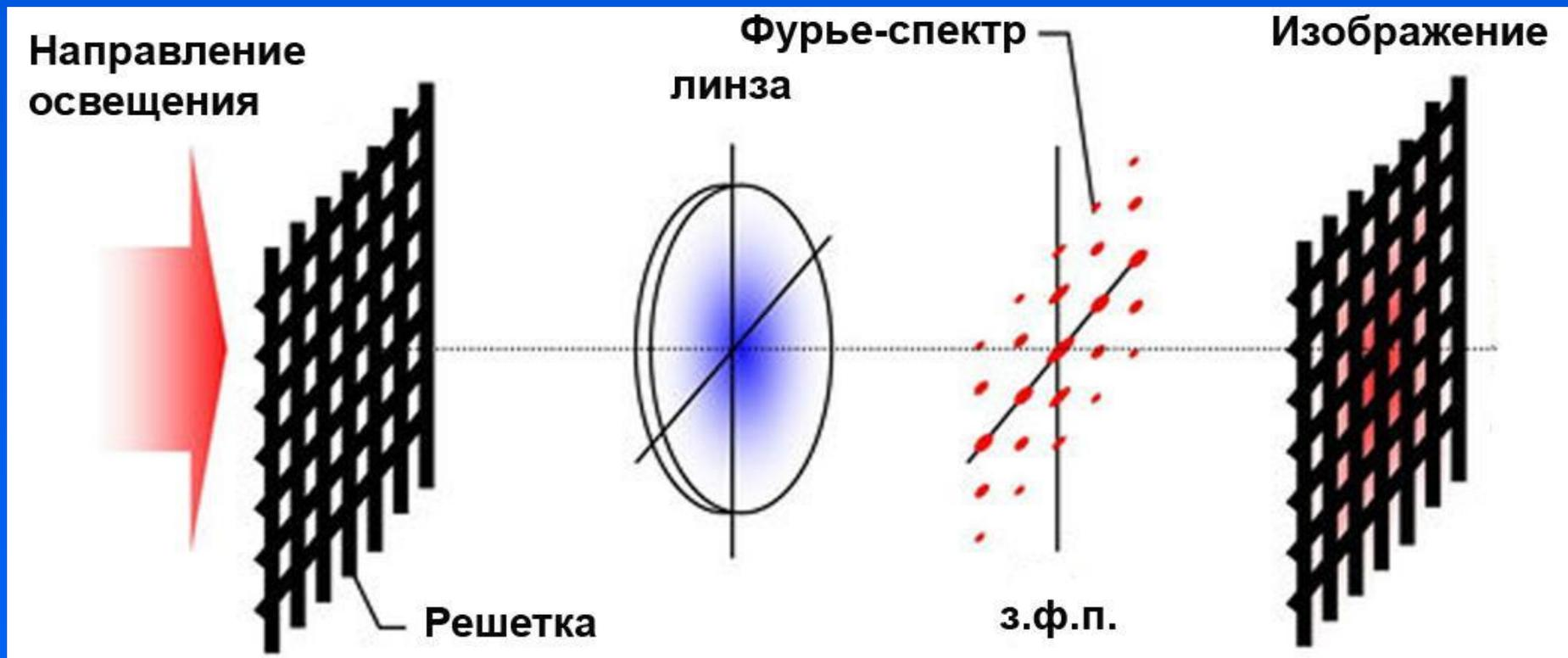
Если объект с регулярной структурой расположен перед передним фокусом идеальной линзы (объектива), то в з.ф.п. появляется его дифракционная картина (двумерный Фурье-спектр). Закрывая в этом спектре часть элементов можно регулировать конечное изображение, формируемое линзой.
