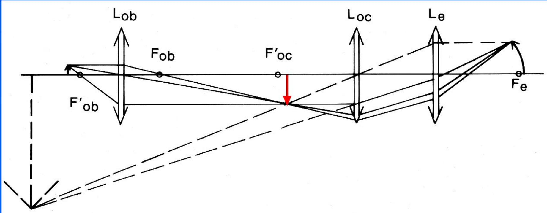
Разрешающая способность микроскопа определяется только изображением, создаваемым объективом. Окуляр используется лишь как лупа для разглядывания этого изображения, и дополнительных деталей не выявляет.
