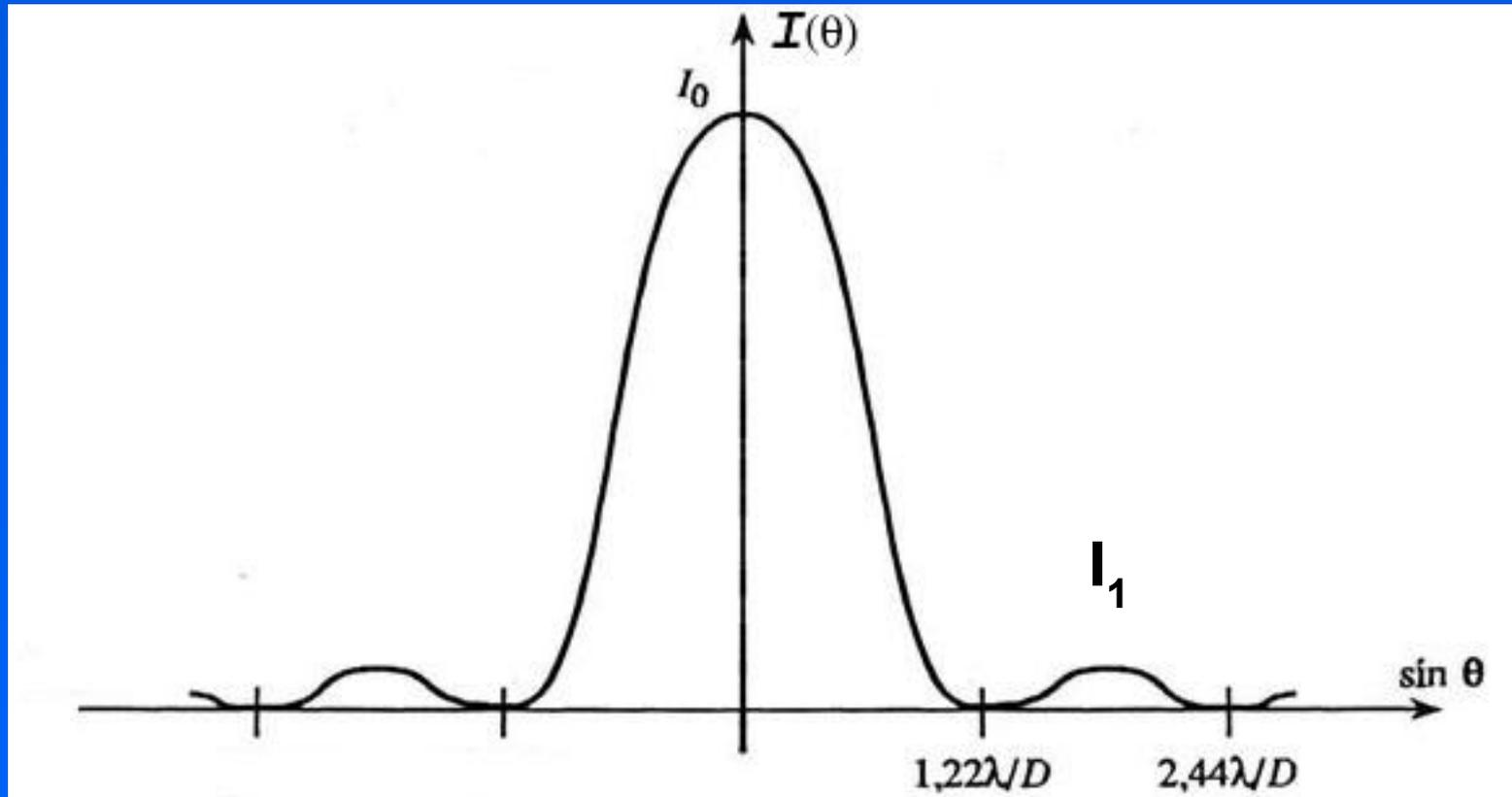
В диске Эри есть центральный (нулевой) максимум и локальные максимумы больших порядков, которые имеют значительно меньшую интенсивность ( $I_1 \sim 2\%$  от  $I_0$ ). Между максимумами интенсивность равна нулю.
