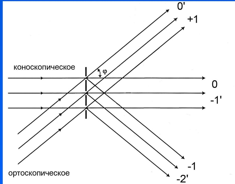
Дифракция на решетке:  $d = \lambda / (\sin i + \sin (f - i))$ , где  $d$  — интервал между элементами решетки,  $\lambda$  — длина волны падающего света,  $f$  — угол отклонения лучей,  $i$  — угол освещения, создаваемый конденсором
