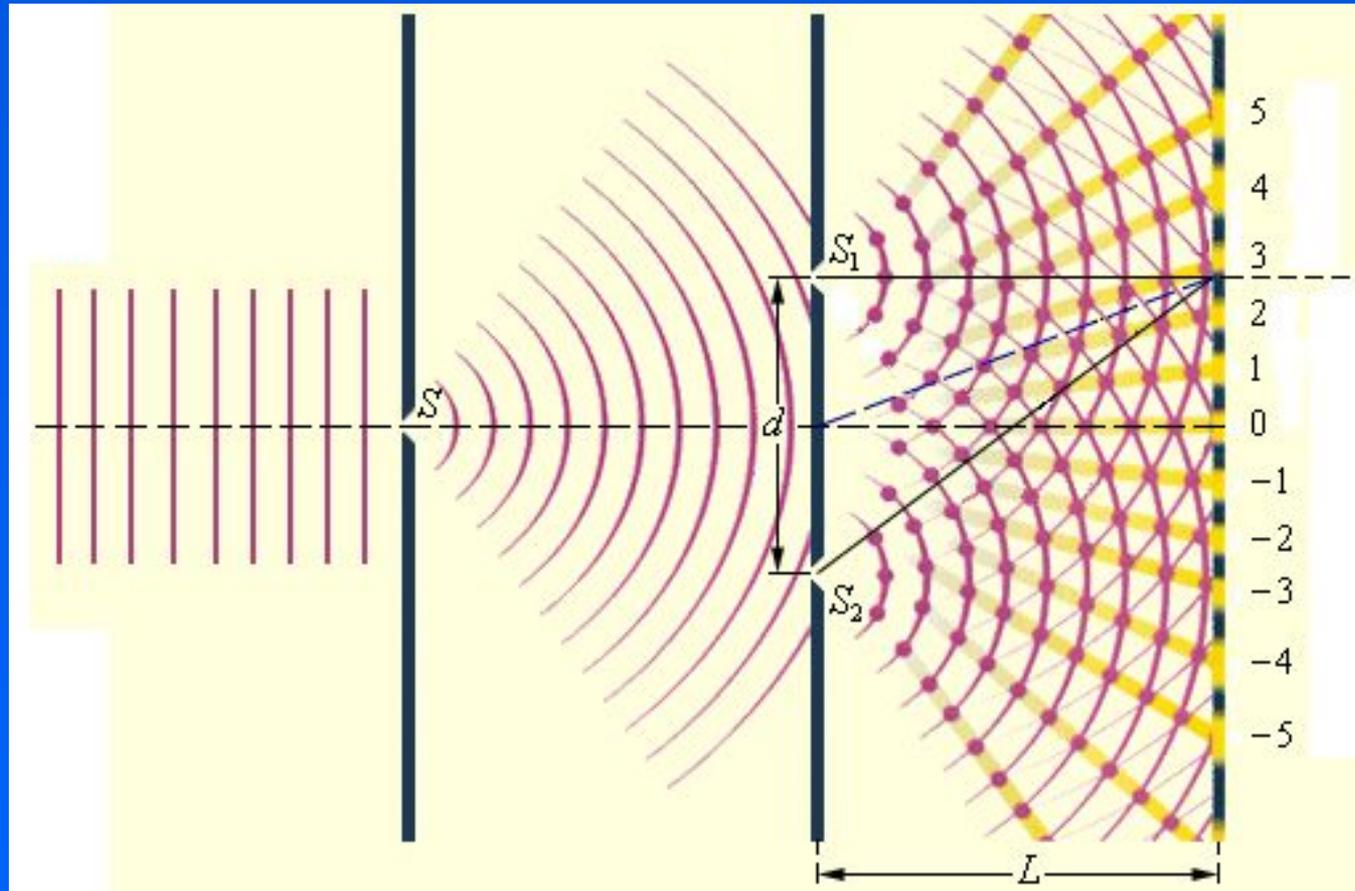
Свет, последовательно проходящий через одну, а затем две щели ( $S$ ;  $S_1$  и  $S_2$ ) создает на экране сложную картину чередующихся полос различной яркости.
