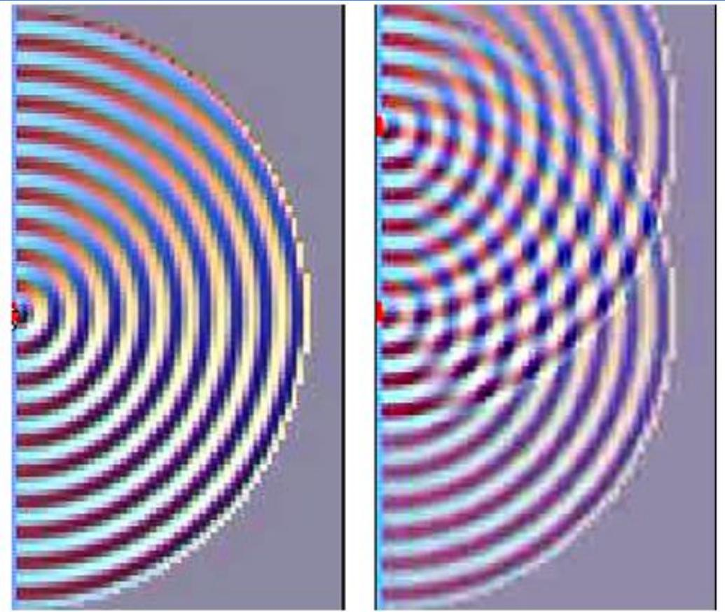
Интерференция волновых фронтов от двух одинаковых источников приводит к образованию псевдо-структур - пучностей и впадин («стоячие волны»). Расположение пучностей и впадин определяется расстоянием до источников волн.
