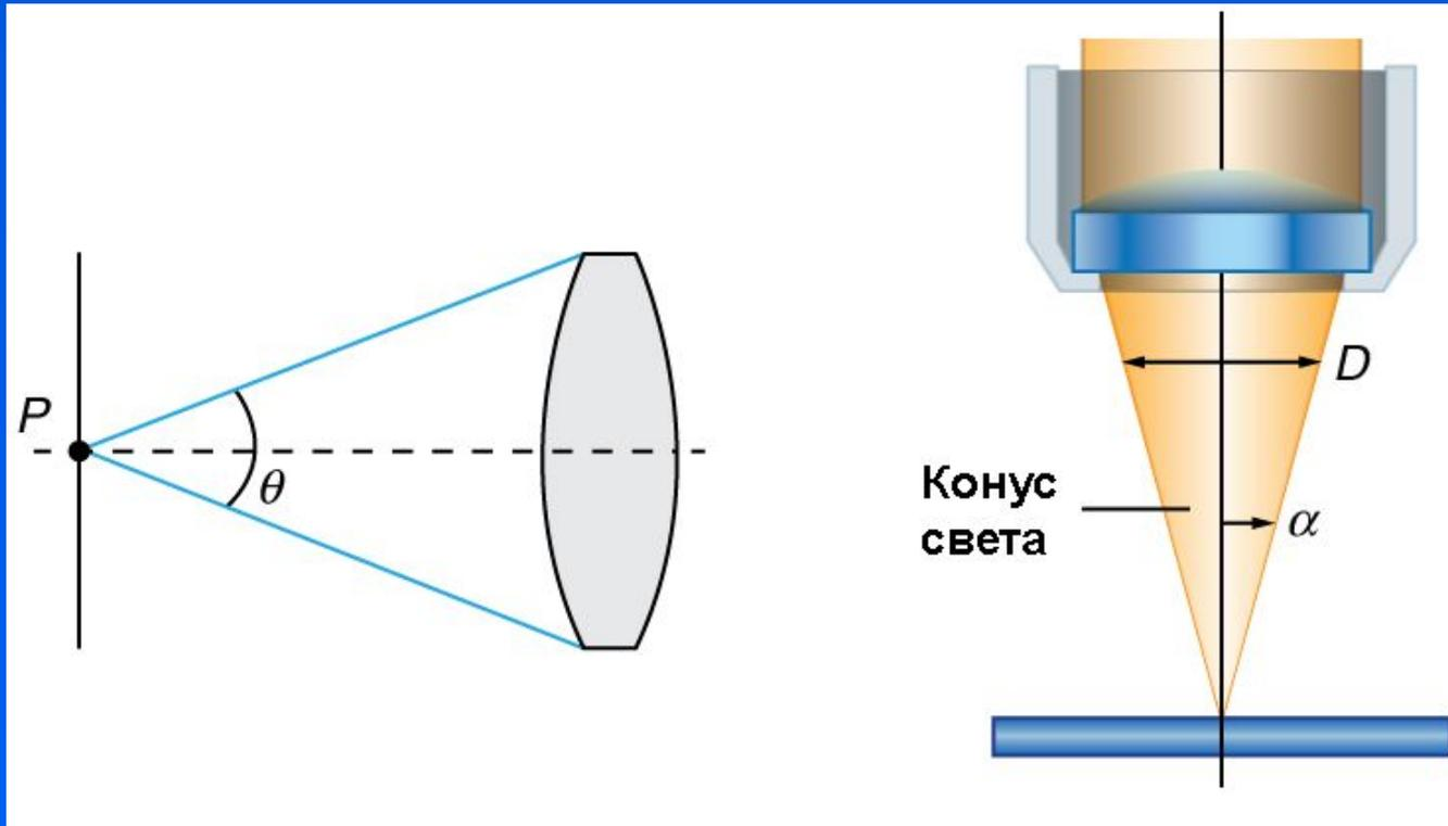
Апертура объектива микроскопа – угол ( $\theta$ ) конуса света, собираемого объективом от предмета, расположенного вблизи фокуса. Апертура определяется соотношением между фокусным расстоянием объектива и диаметром его входного зрачка ( $D$ ).
