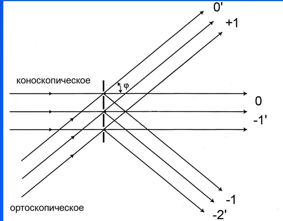
При использовании косого света (ортоскопическое освещение) максимальный угол дифракции света, собираемого объективом ( $\varphi$ ) удваивается. Соответственно разрешение микроскопа становится в два раза лучше:  $0,5 \lambda / NA_{об.}$
