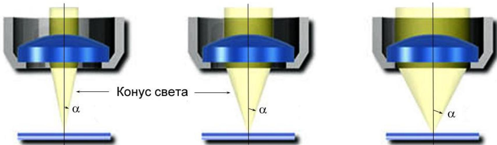
Апертура определяется соотношением между фокусным расстоянием объектива и диаметром его входного зрачка (D).
