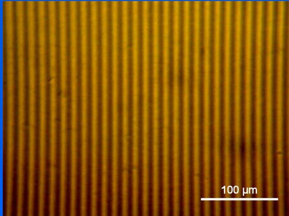
Дифракционная решетка – система параллельных (прозрачных) щелей, разделенных непрозрачным промежутком, ширина которого примерно равна ширине щелей.
