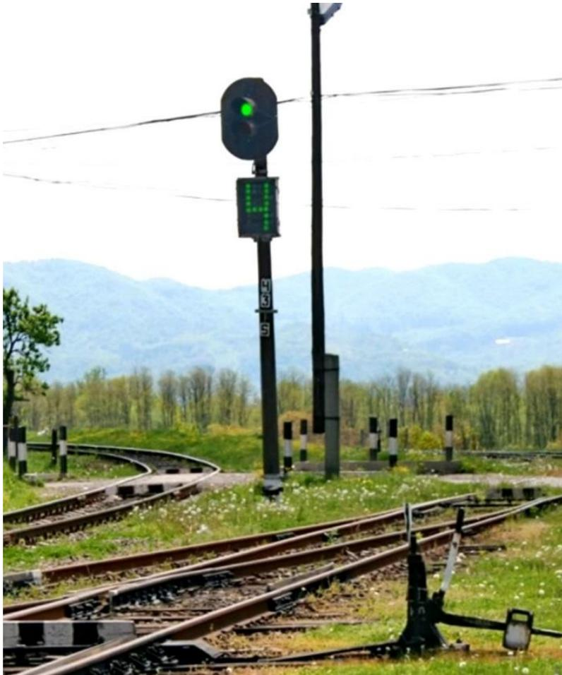
При полуавтоматической блокировке разрешением на занятие поездом **перегона** или **межпостового участка** служит разрешающее показание выходного или проходного светофора.
