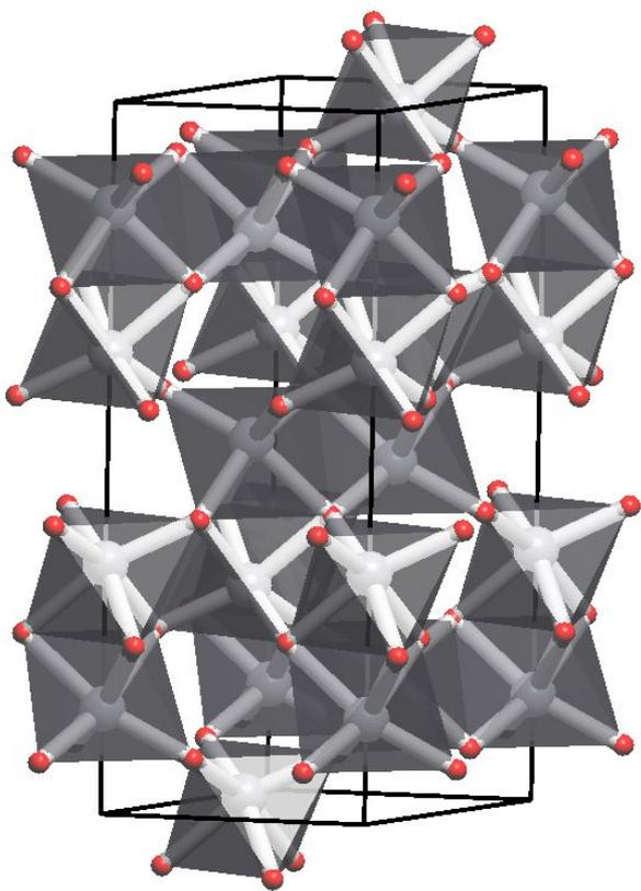
$\text{Al}_2\text{O}_3:\text{Cr}$  - рубин
