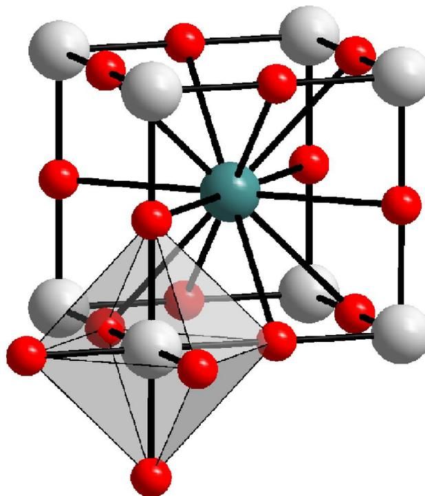
$\text{BaTiO}_3$  (сегнетоэлектрик  $T_c = 120^\circ\text{C}$ )
