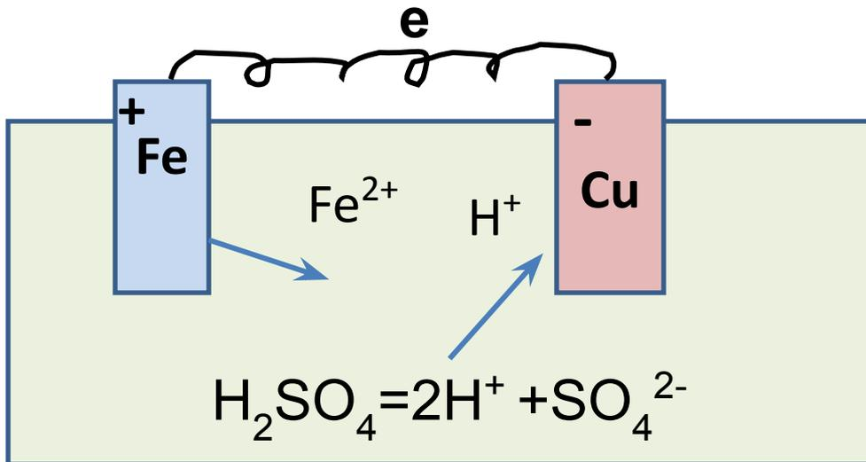
При контакте двух металлов разрушается (окисляется)
