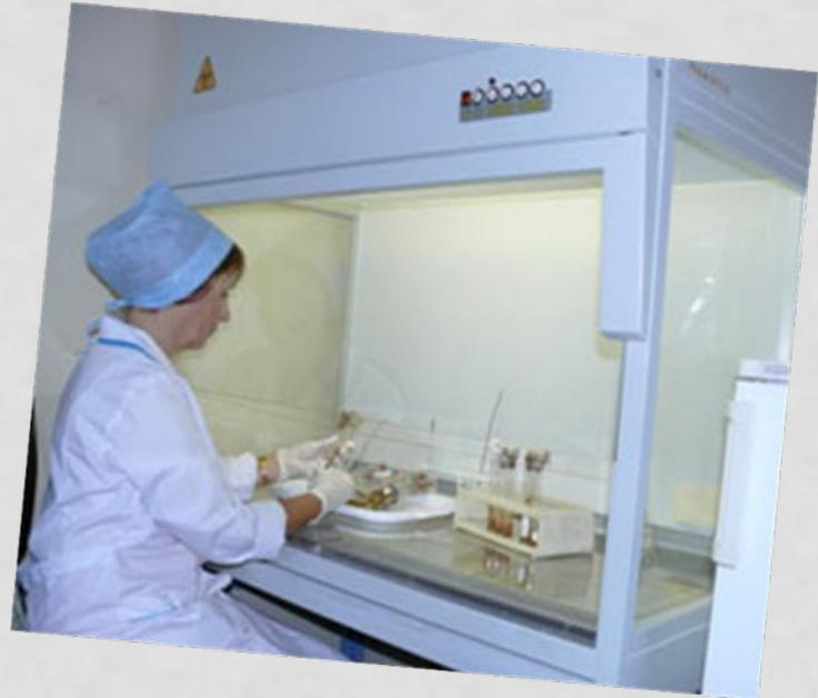
Перед началом работы ламинатор должен быть вымыт с помощью растворов нейтральных детергентов и все доступные внутренние его поверхности должны быть простерилизованы химическими дезинфектантами (70%-й этанол). В течение работы ламинатор необходимо мыть раз в месяц, снимая съемные детали поверхности и прочищая пространство под ними. После промывки панели прибора вновь стерилизуют этанолом.
