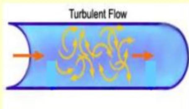
**Турбулентное течение** - это течение жидкости «с завихрениями», для которого характерно наличие нормальной (перпендикулярной направлению течения жидкости) составляющей скорости движения молекул. Его траектория представляет собой сложную кривую линию.
