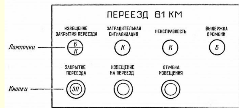
Индикация переездной сигнализации на табло ДСП
