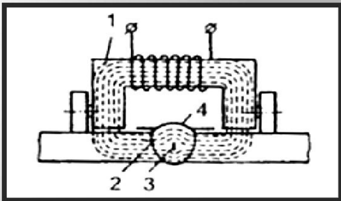
Проверка качества сварных швов магнитной дефектоскопией: 1 - магнит, 2 - сварной шов, 3 - дефект, 4 - магнитная пленка.
