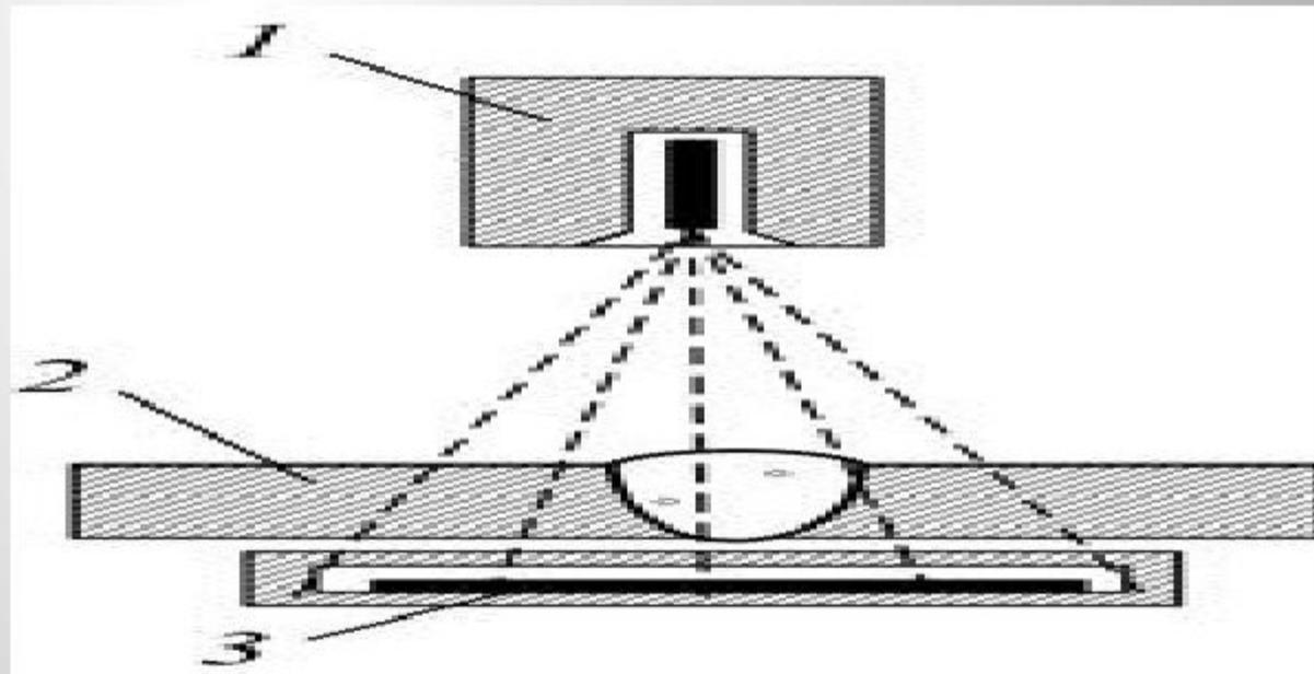
Схема просвечивания сварного соединения: 1 – источник излучения, 2 – изделие, 3 – чувствительная пленка
