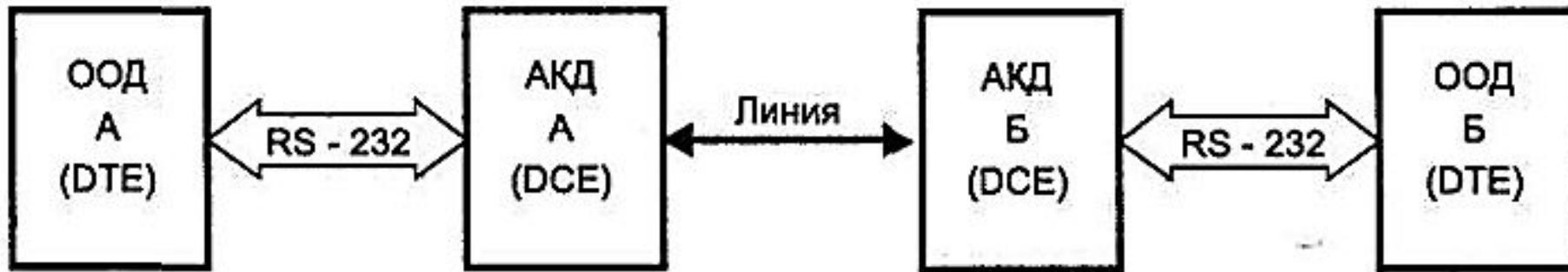
DTE (Data Terminal Equipment) – окончное оборудование данных (ООД), например, компьютер
