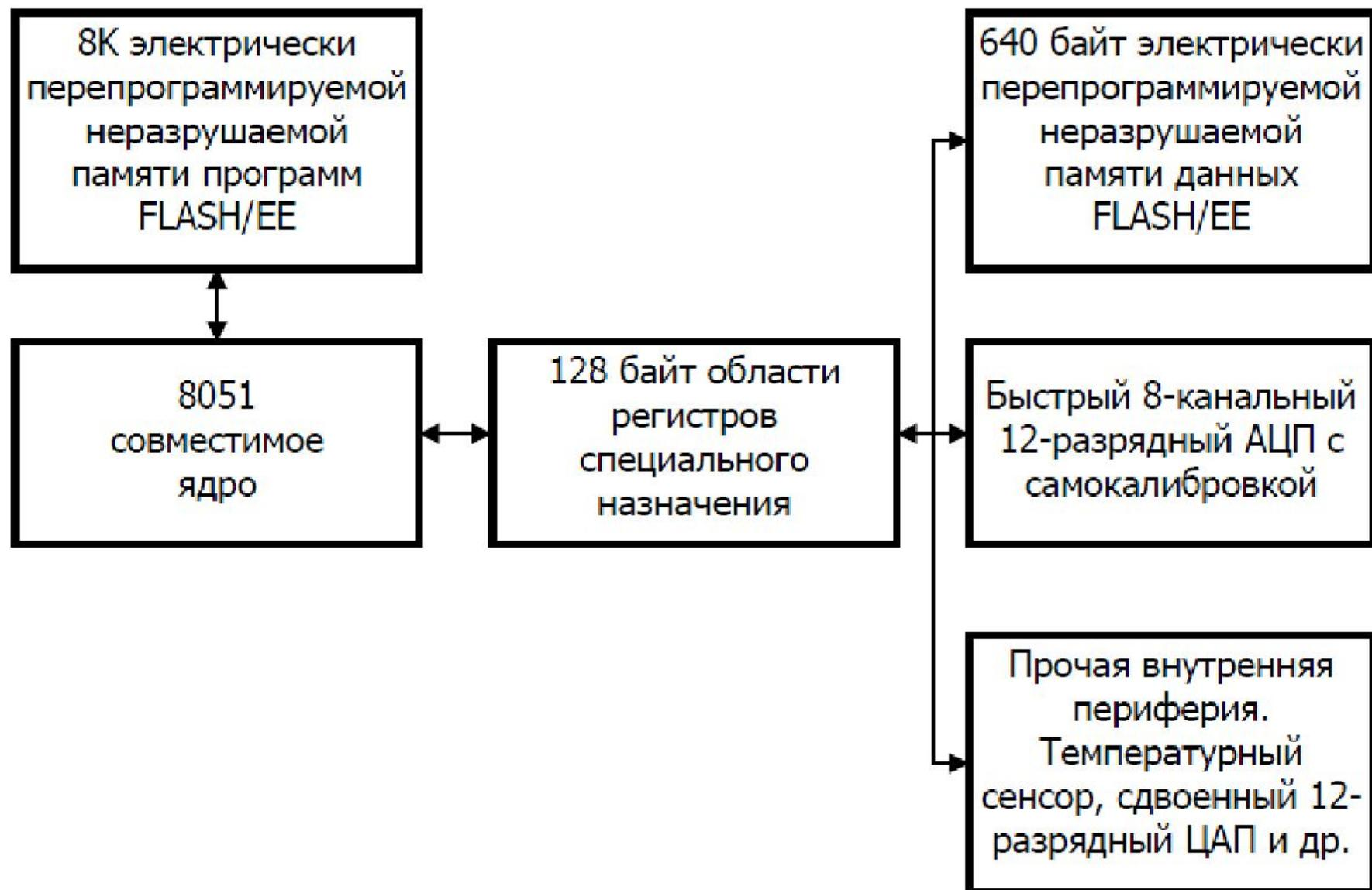
Блок АЦП включает в себя восьмиканальный пяти микросекундный А/Ц преобразователь с однополярным питанием. Пользователю предоставлены многоканальный мультиплексор, устройство выборки-хранения, встроенный ИОН, система калибровок и собственно АЦП. Все компоненты блока легко управляется через три интерфейсных регистра специального назначения.
