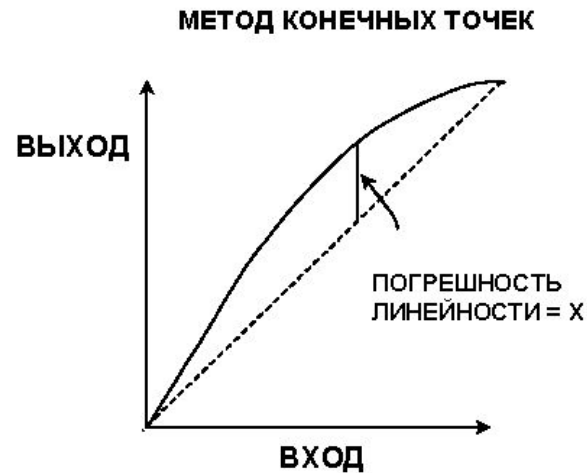
Рисунок 6 – Метод измерения суммарной погрешности линейности – метод конечных точек
