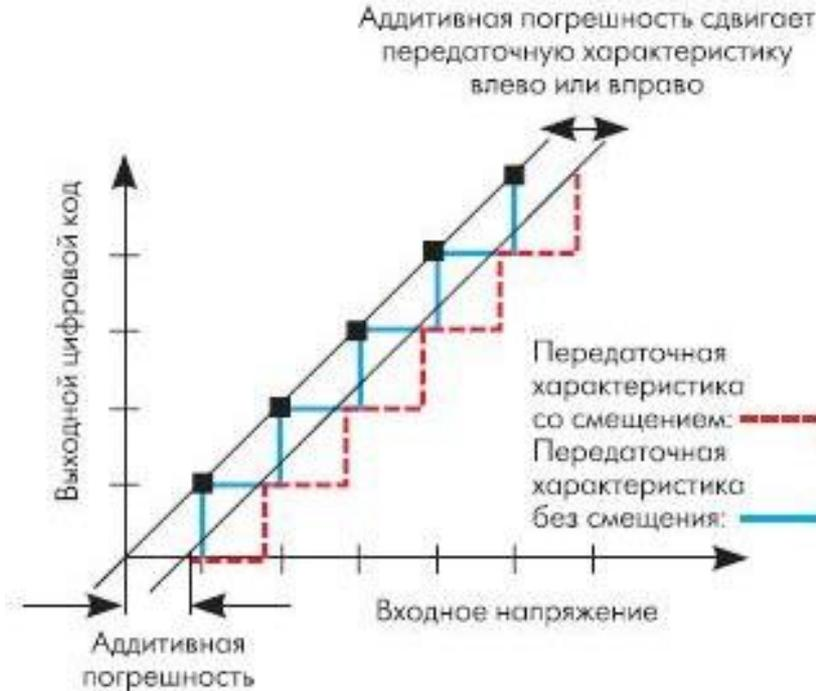
Рисунок 4 – Аддитивная погрешность
