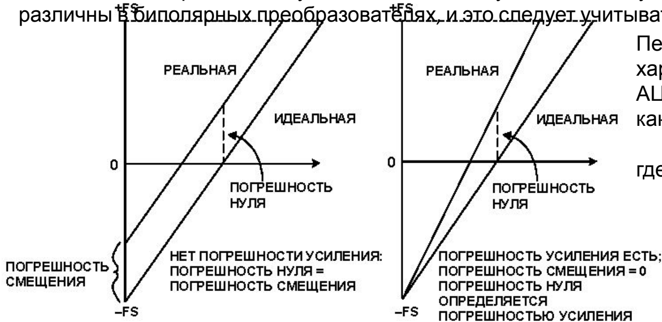
Рисунок 3 – Погрешность смещения нуля преобразователя и погрешность усиления
