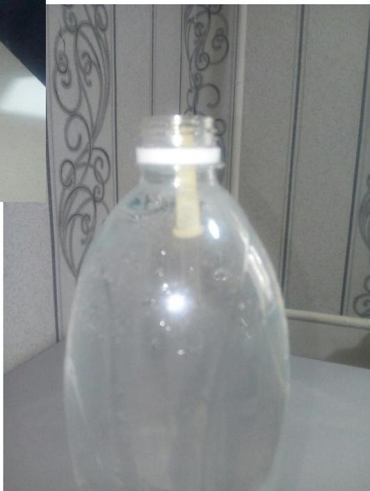
Бутылка наполнена водой на два-три миллиметра до края горлышка. Пипетка, с небольшим количеством воды, опущена в горлышко бутылки. Она от легкого толчка пальцем погружается, а потом сама снова всплывает. Закрутив бутылку пробкой, нажать на боковые стенки бутылки. Пипетка пойдет на дно бутылки. Если ослабить давление пальцев или ладони - она снова всплывет. Можно, регулируя силу нажатия на бутылку, заставить пипетку «зависнуть» на одном уровне.
