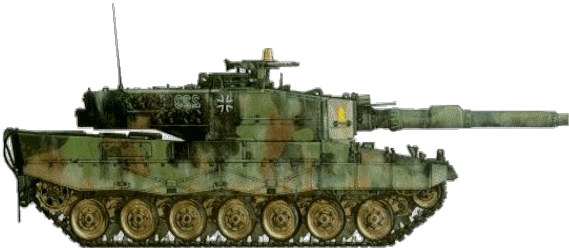
**Танк Леопард 2** разрабатывался в 1967 — 1979 годах фирмами Krauss-Maffei AG (генподрядчик), Porsche (общие вопросы проектирования конструкции и детальная разработка ходовой части), Wegmann (башня) и AEG Telefunken (система управления огнем) после прекращения совместных с США работ по созданию перспективного танка MBT-70.
