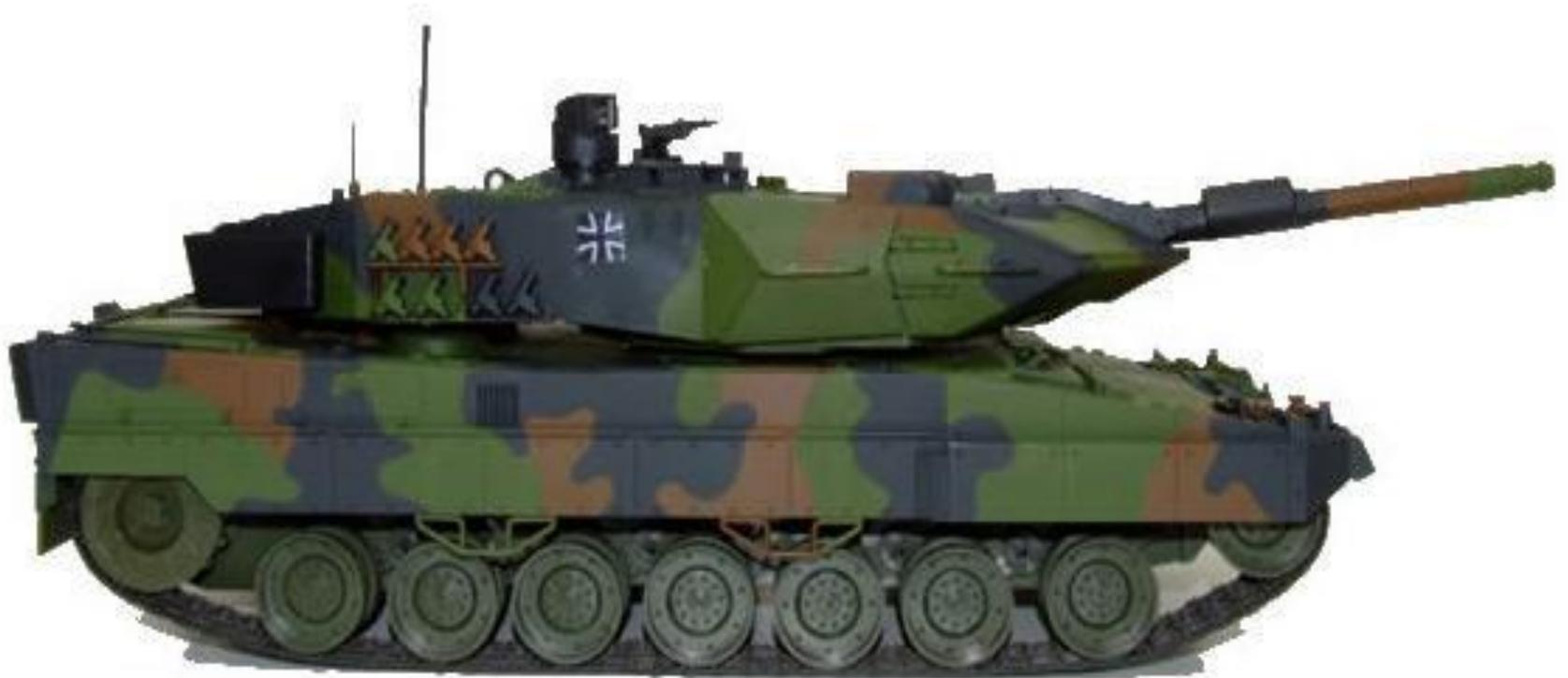
**Леопард 2А5 (1995 - 1998 гг.)** - на лобовых деталях башни и корпуса установлены модули накладной брони с элементами встроенной динамической защиты введен противоосколочный подбой, электропривод стабилизатора модернизированная СУО Krupp Atlas.
