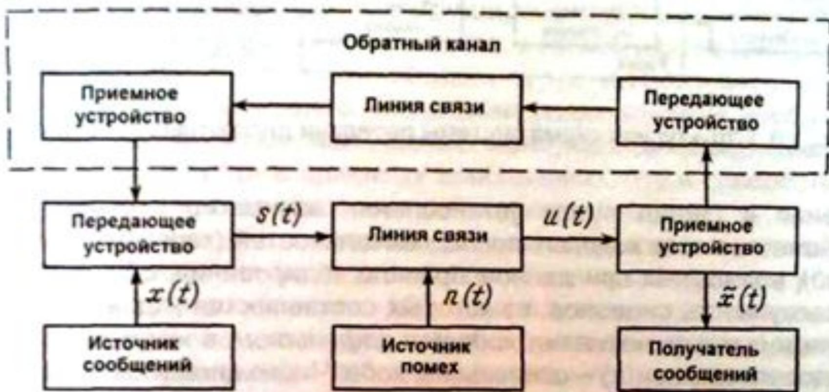
Структурная схема радиотехнической системы передачи информации
