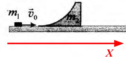
$$m_1 \vec{v}_0 = (m_1 + m_2) \vec{v}; \quad OX: \quad m_1 v_0 = (m_1 + m_2) v$$
