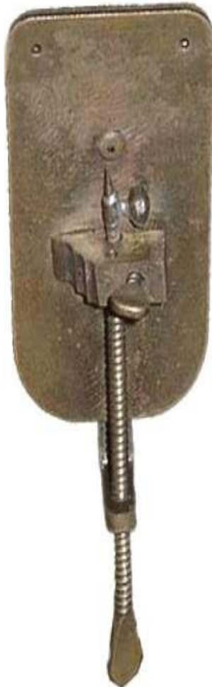
Микроскоп Левенгука XVII века с увеличением до 300х
