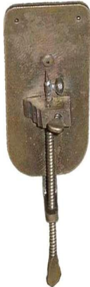
Микроскоп Левенгука XVII века с увеличением до 300х
