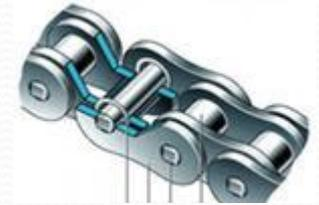
Широкое применение цепных передач началось с появлением втулочных и втулочно-роликковых цепей, обеспечивающих передачу мощности до 5000 кВт при высоких скоростях движения (до 35 м/сек), больших усилиях (до 700 Мн с несколькими параллельными контурами многорядных цепей)
