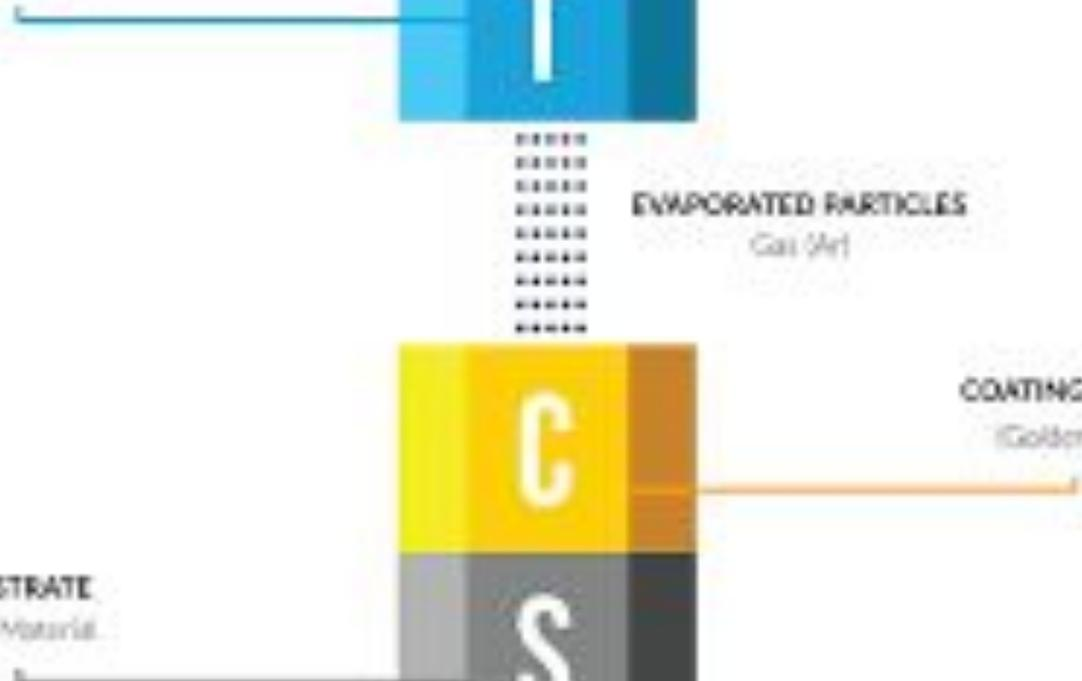
Для равномерного нанесения покрытия необходимо систематизированное движение материала или применение нескольких, определенным образом расположенных, источников. В то же время, поскольку покрытие наносится только на поверхности "в прямой видимости источника", метод позволяет селективно наносить покрытие только на определенные части поверхности, оставляя другие без нанесенного слоя.
