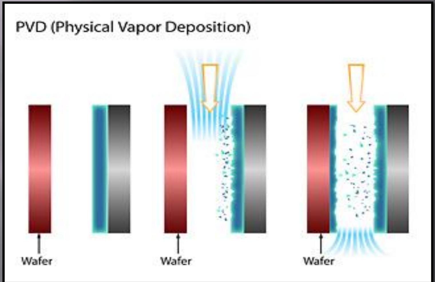
При физическом осаждении (PVD) материал покрытия переходит из твердого состояния в газовую фазу в результате испарения под воздействием тепловой энергии или в результате распыления за счет кинетической энергии столкновения частиц материала. Энергия, распределение и плотность потока частиц определяются методом нанесения, параметрами процесса и формой источника частиц.
