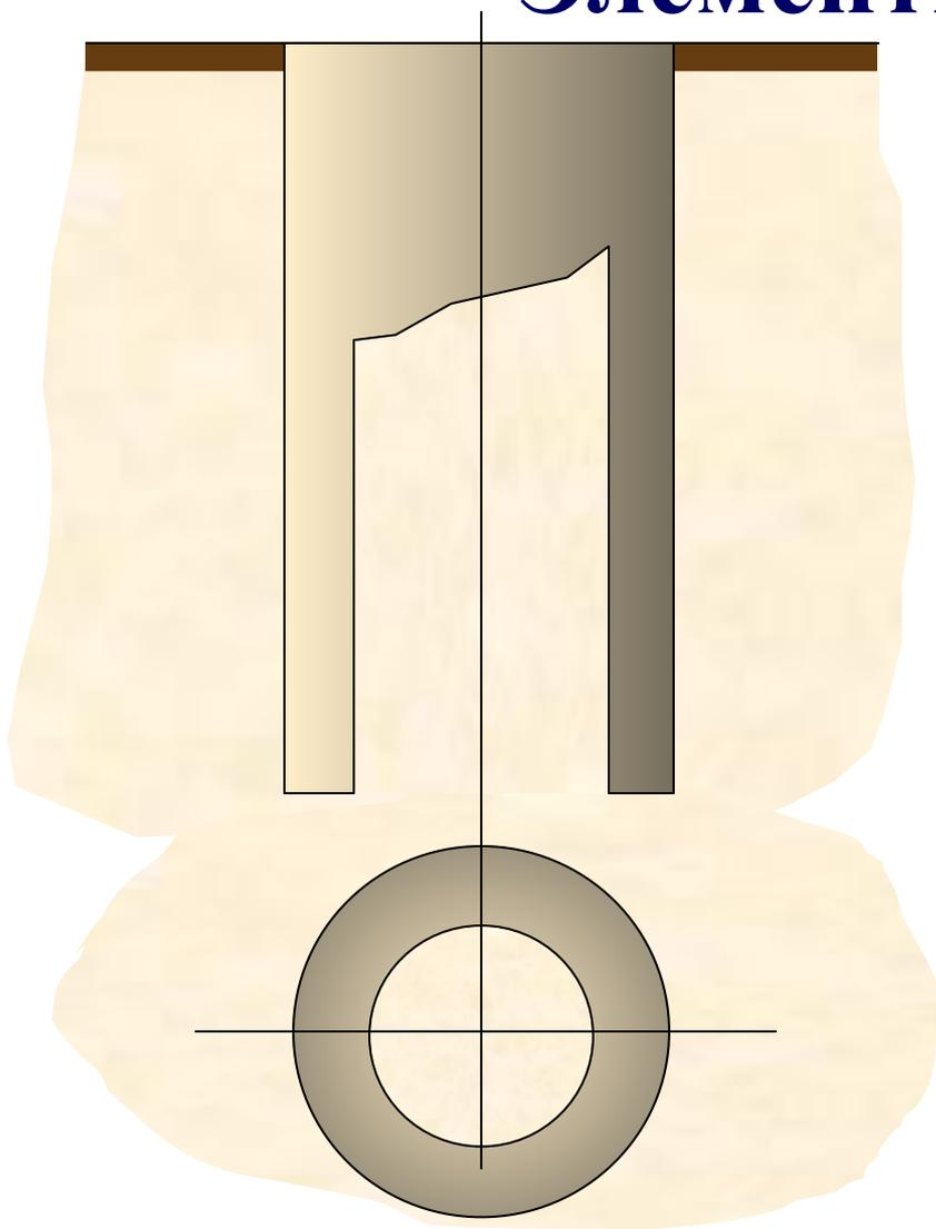
*Колонковое бурение — бурение, при котором горная порода разрушается по кольцевому забою с столбика выбуриваемой породы - керна*
