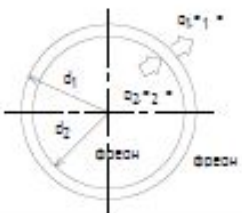
Схема теплообмена в промежуточном теплообменнике
