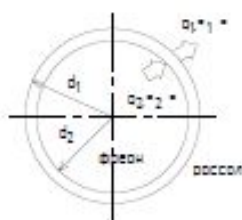
Схема теплообмена в промежуточном теплообменнике
