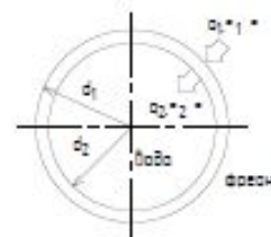
Схема теплообмена в охладителе
