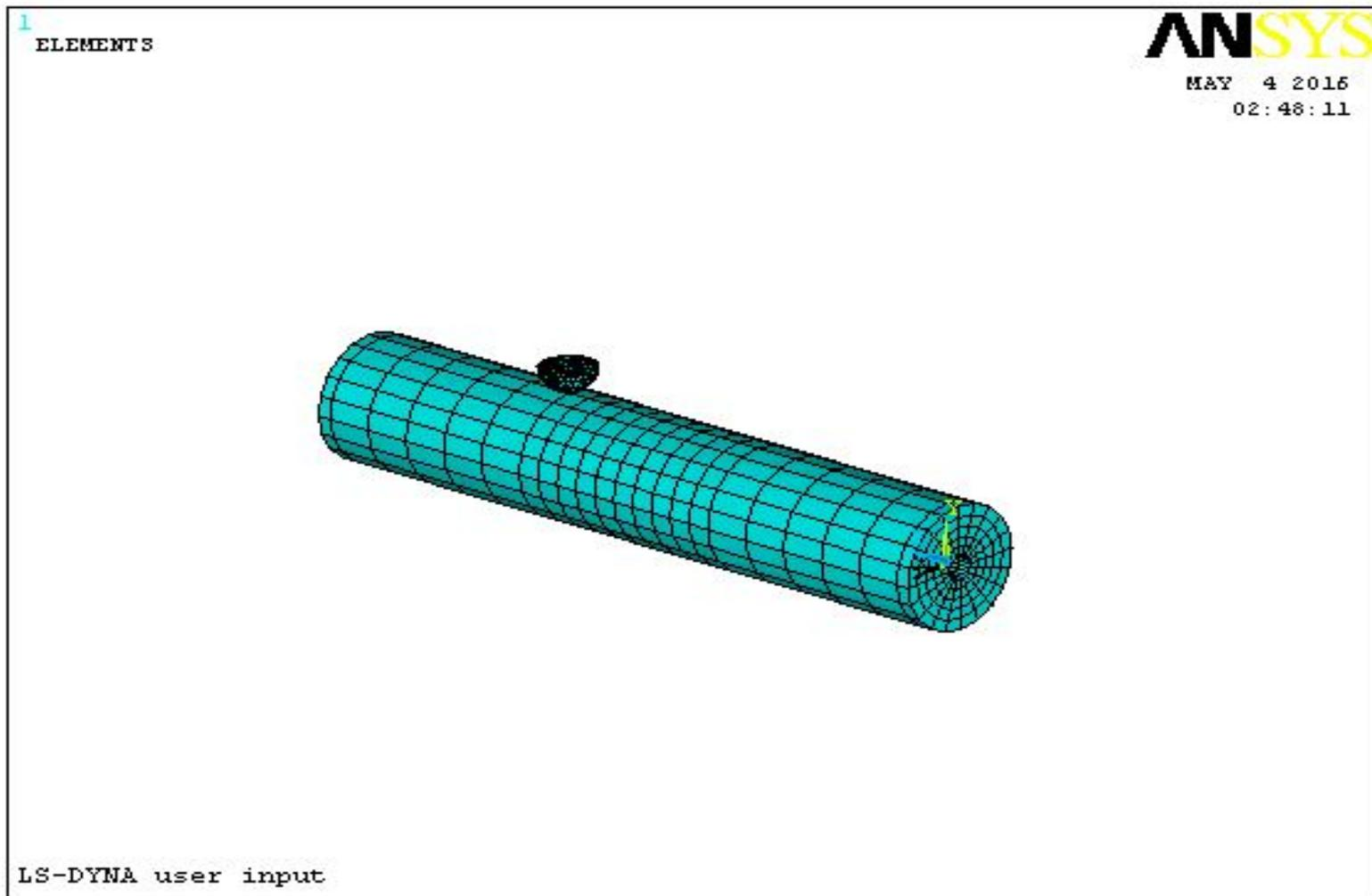
Для описания граничных условий создавались массивы времени, усилия обкатки, вращения заготовки и перемещения алмаза. Так как алмаз имеет продольную подачу, а частота вращения заготовки  $160 \text{ мин}^{-1}$ , то для обкатки участка образца длиной 5 мм потребуется 10-12 секунд. Массивы для задания граничных условий упрочнения алмазным выглаживанием с продольной подачей представлены в таблице 2.
