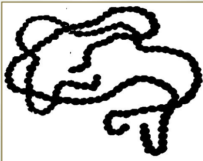
Трехмерная модель единичной макромолекулы и взаимное переплетение перекрытие двух макромолекул, помещенной в поле случайных сил.
