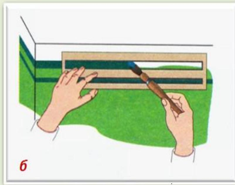
Стык двух красок разного цвета не всегда бывает ровным, поэтому место стыка закрашивают ровной полоской краски другого цвета - филенкой. Филенку проводят (отводят) по линейке (*рис. а*) или трафарету (*рис. б*).
