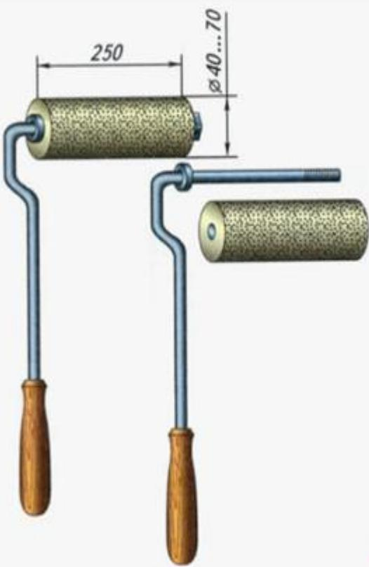
Для окрашивания больших плоскостей (потолков, стен) применяют **валики** (рис. а). Валиками можно нанести более ровный, чем кистью, слой краски, а также выполнить малярные работы с большей производительностью. Изготавливают валик из меха или поролона.
