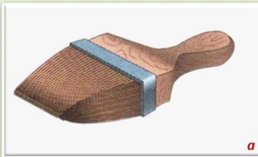
*Побелочные кисти* (*рис. а*) имеют ширину до 200 мм, толщину 45 ... 65 мм и длину волоса 100 мм.
