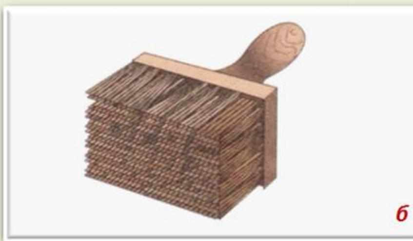
*Макловицы* (*рис. б*) - это плоские кисти шириной 25 ... 100 мм, изготовленные из высококачественной щетины или из барсучьего волоса. Их применяют для сглаживания свеженанесенной краски.
