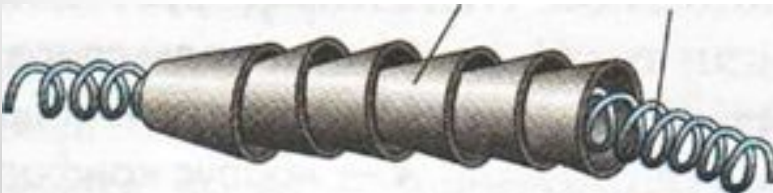
Закрытый нагревательный элемент: 1 — изоляционные бусы, 2 — спираль
