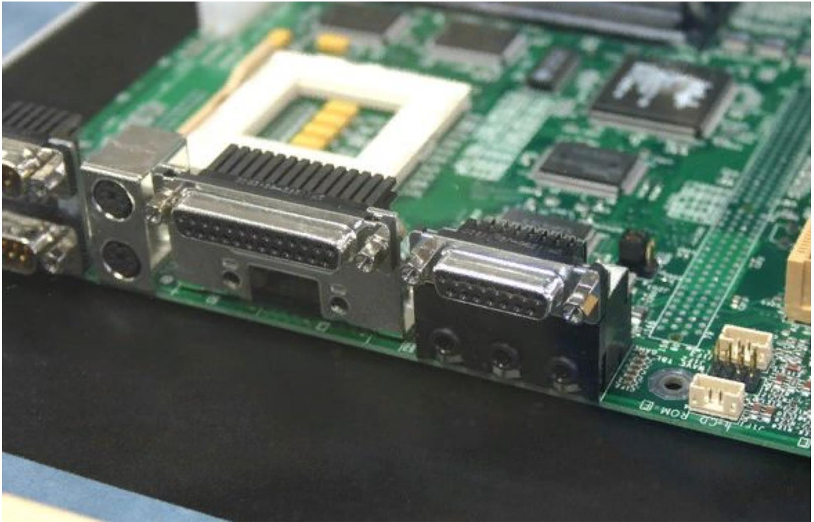
Задняя панель ввода/вывода, интегрированы последовательный, параллельный и игровой порты.
