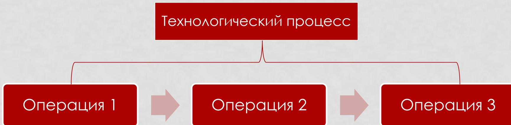
Операция — часть технологического процесса, выполняемая на одном рабочем месте (станке, стенде, агрегате и т.д.), одним или несколькими рабочими, состоящая из ряда действий над каждым предметом труда или группой совместно обрабатываемых предметов
