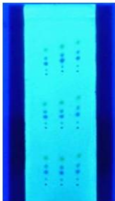
Рис. 3. Разделение пятикомпонентных систем методом ПЭХД на LiChrospherC18 пластинах при 59 атм. и 7 кВ [A. Mendes, L.C. Branco, C. Morais, A.L. Simplicio. // Electrophoresis. 2012. V. 33. P. 1182–1190.].
