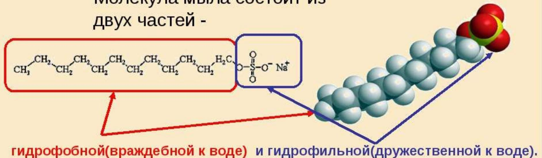
В воду мыло погружается гидрофильной частью, а гидрофобная выталкивается наружу.
