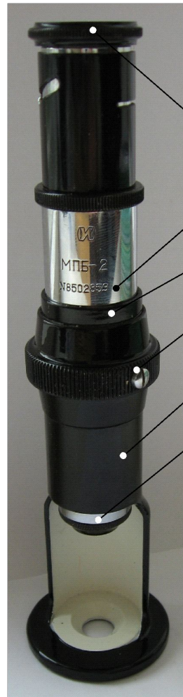
Рис. 1. Определение диаметра отпечатка с помощью шаблона
