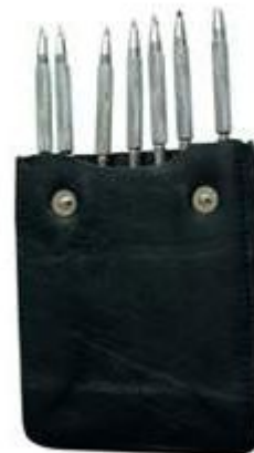
Рис.2. Набор карандашей для определения твердости по Моосу.
