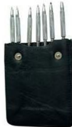
Рис.2. Набор карандашей для определения твердости по Моосу.
