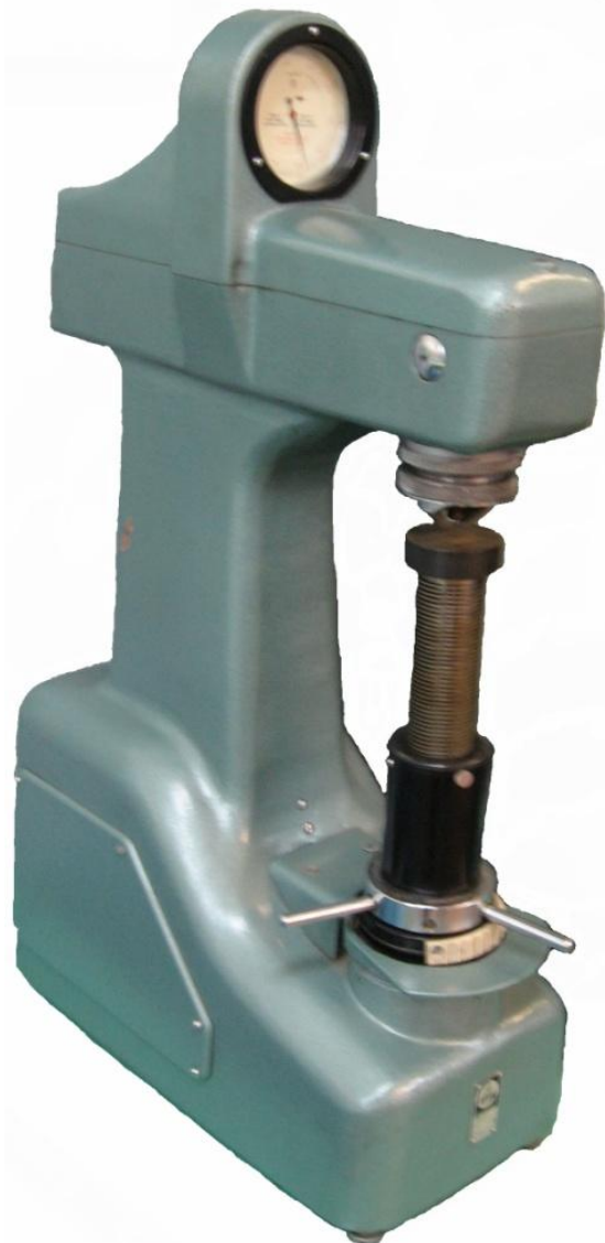
Рис. 1. Общий вид прибора Роквелла
