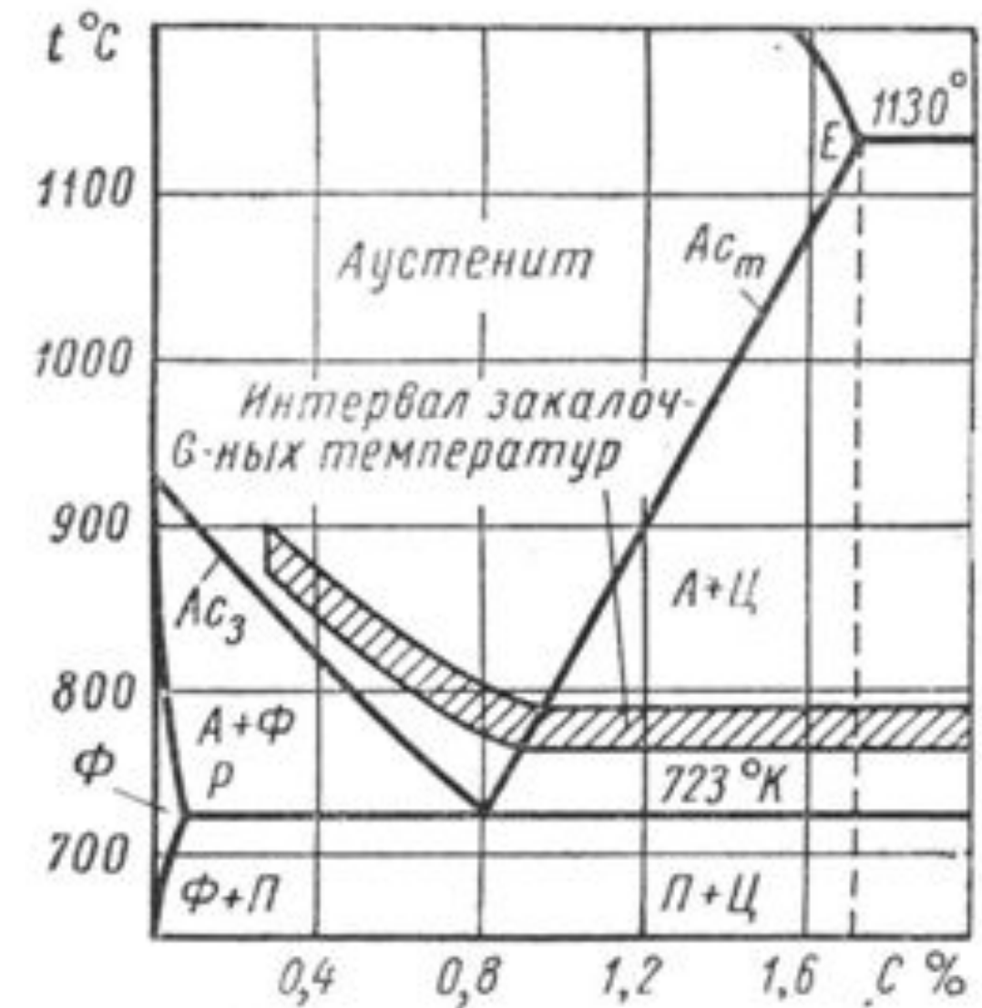
Диаграмма интервалов закалочных температур для углеродистых
