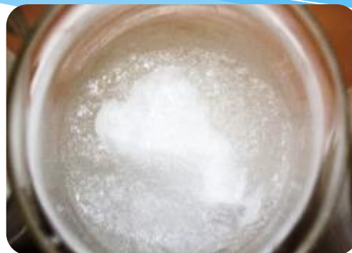
Концентрация раствора 20 % Время заморзания 96 ч
