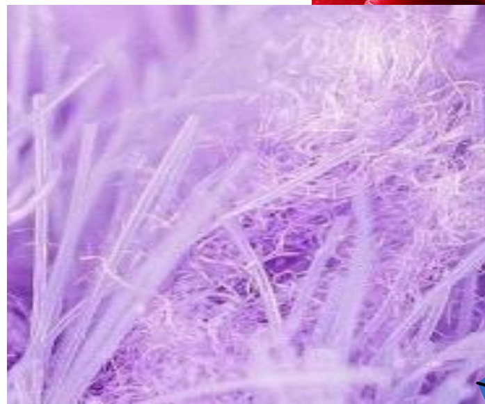
Микроволокно ИНВОЛВЕР под микроскопом
