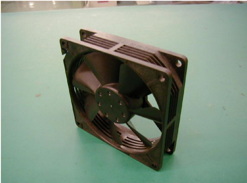
Модель вентилятора с открытым корпусом дает понижение шума на 6 дБА при схожих характеристиках
