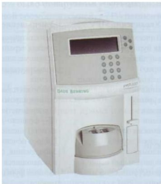
Рис. 73. Динамический агрегометр PFA-100. Он позволяет наблюдать in vitro за процессом закупорки сосуда при моделировании этого процесса в специально созданном картридже. Образование тромбоцитарной пробки оценивается по перфузионному давлению
