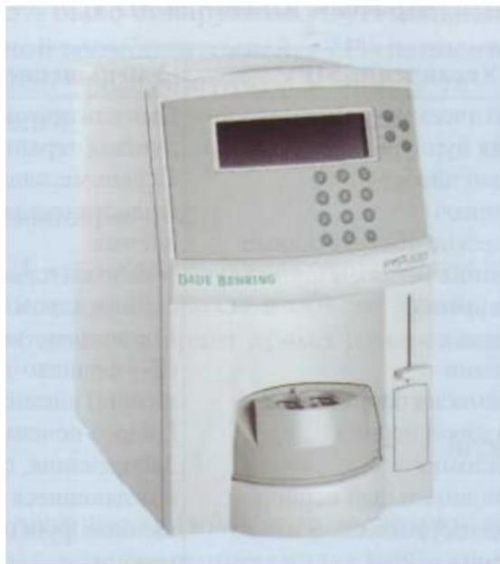
Рис. 73. Динамический агрегометр PFA-100. Он позволяет наблюдать *in vitro* за процессом закупорки сосуда при моделировании этого процесса в специально созданном картридже. Образование тромбоцитарной пробки оценивается по перфузионному давлению
