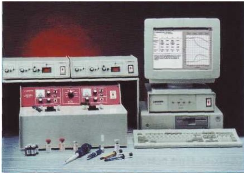
Рис. 77. Агрегометр «Chrono-log», исследующий агрегацию тромбоцитов на цельной крови электронно-импедансным методом
