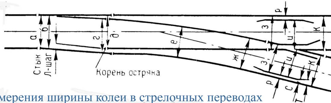
Места измерения ширины колеи в стрелочных переводах
