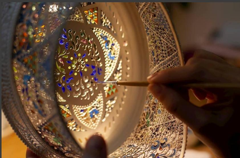
После того, как заложены все цвета, проверяем на текучесть - заполняем изделие горячей водой и оставляем на день. От натяжения металла при обжиге могут возникать невидимые глазу отверстия, поэтому важно проверить и, в случае обнаружения, устранить возникший дефект. Посуда протекать не должна.
