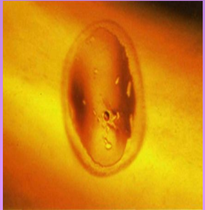
Рис. № 8. Включения в термообработанных корундах.
