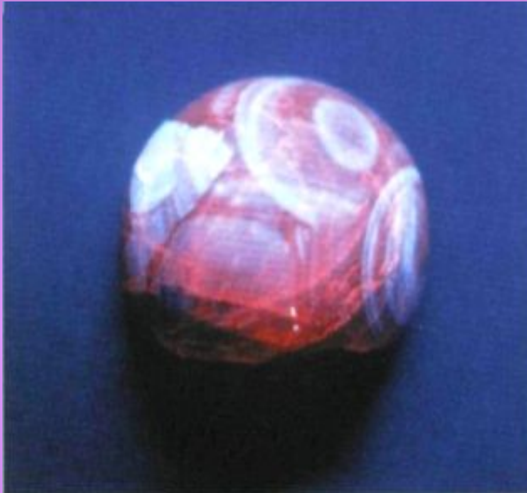
Рис. № 26. В термически обработанных корундах часто проявляется белесая люминесценция.
