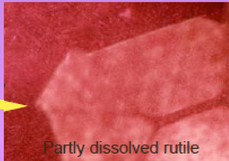
Рис. № 1. Растворение игл рутила при нагревании.
