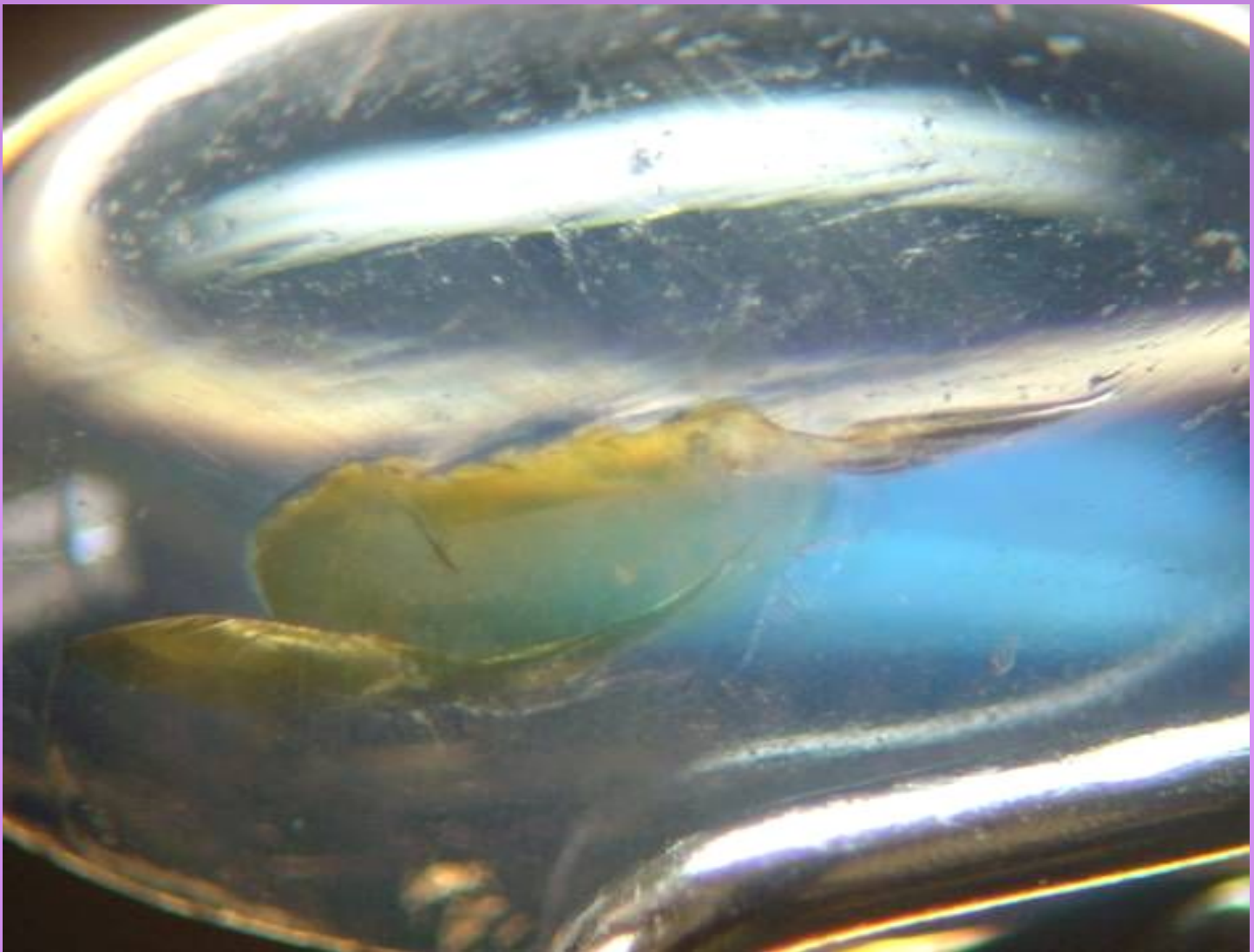
Рис. № 30. Трещины, декорированные окислами железа.
