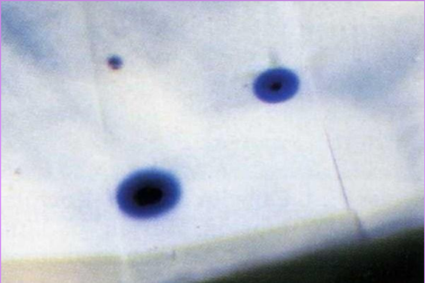
Рис. № 16. Ореолы внутренней диффузии вокруг включений, содержащих титан.
