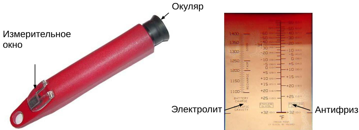
Проверка плотности электролита в элементах батареи. Измерительным стержнем заберите некоторое количество электролита, нанесите его измерительное окно, повернуть окно к источнику света и, держа плотномер горизонтально, через окуляр считайте показание по границе между темной и светлой частями шкалы.
