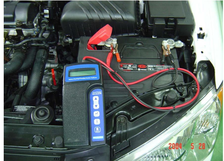
Прибор спросит, подключена ли батарея «НА АВТОМОБИЛЕ» (IN VEHICLE) или «ВНЕ АВТОМОБИЛЯ» (OUT OF VEHICLE). Выбрать нужное кнопками со стрелками и нажать кнопку “ENTER”.
