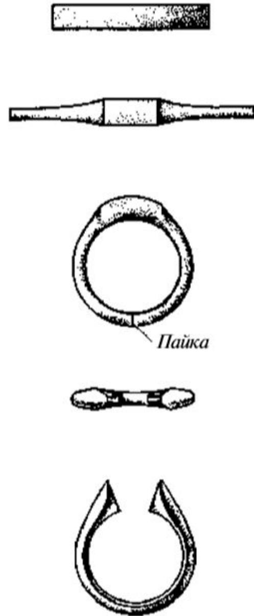
схема изготовления кованой шинки.
