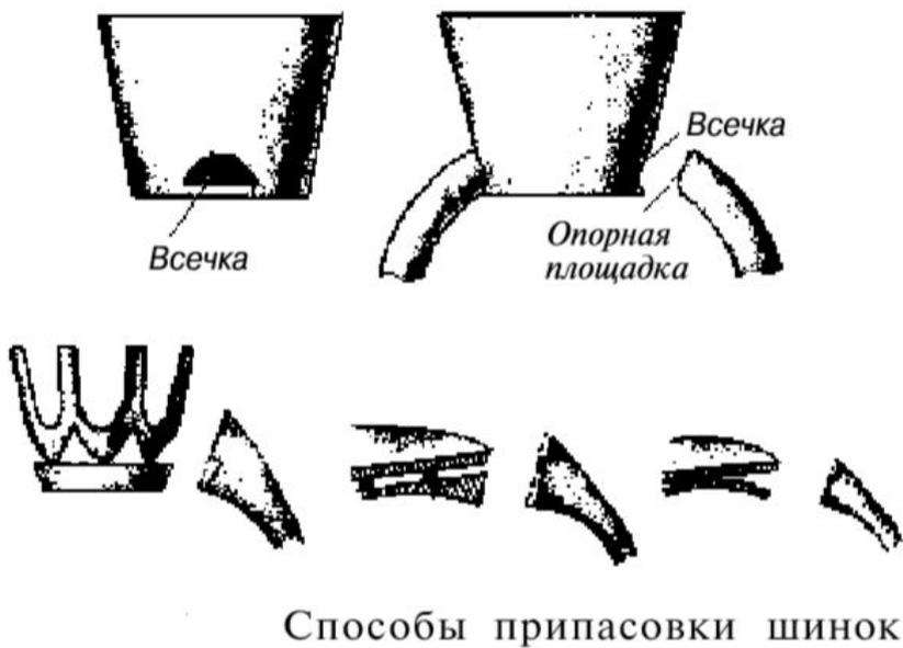
К верхушке с дикелем опорные площадки шинки запиливают по форме дикеля, чтобы обеспечить плотное прилегание опорной площадки по всей высоте дикеля и верхушки. Во всех случаях шинку припасовывают, соблюдая нижний и верхний пределы совмещения шинки с кастой или верхушкой.
