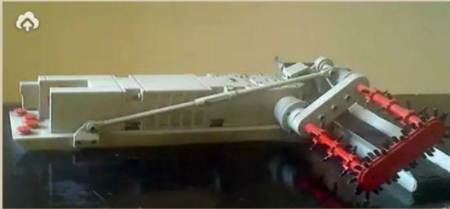
Рисунок 4. Модель комбайна Б-1 А. И. Бахмутского (предположительно фото сделано в музее Горловского машиностроительного завода)
