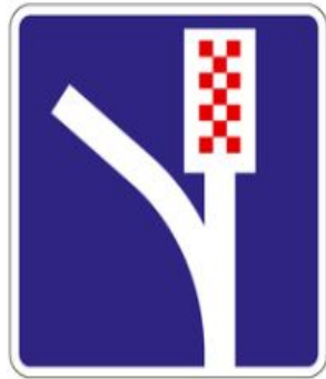
6.5 Полоса для аварийной остановки
