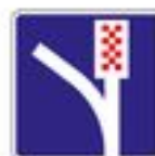
6.5 Полоса аварийной остановки
