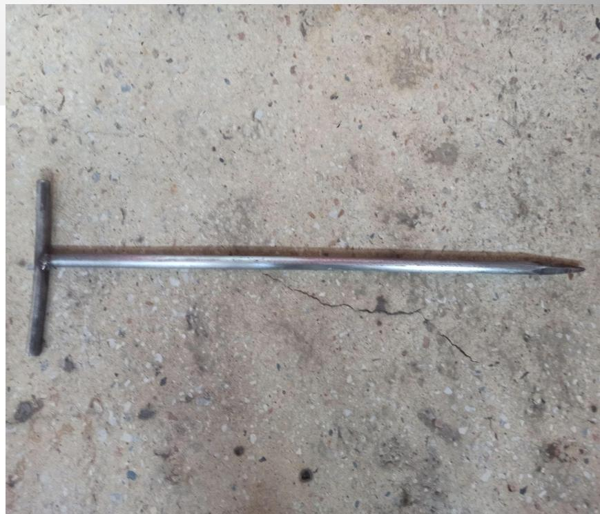
**2) На штырь заземляющего устройства наносится отметка указывающая требуемую глубину его забивания в грунт на расстояние от острия не менее 0,7 м (далее 70 см). Отметка наносится краской яркого цвета, клейкой лентой и т.д.**
