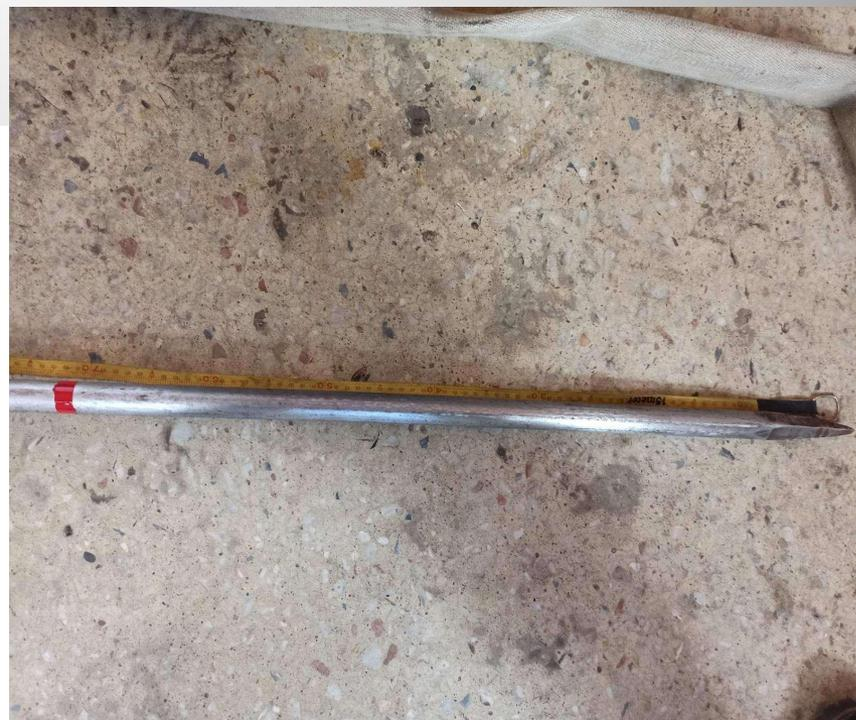
**3) Для предотвращения появления ржавчины и коррозии на заземляющий штырь наносится небольшой слой солидола.**
