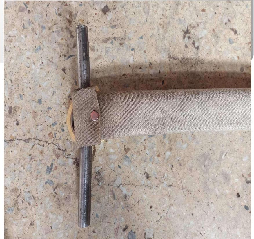
**2) На чехол с одной стороны наносятся минимально допустимые расстояния от насадки пожарного ствола, с другой стороны наносится минимальная глубина забивания в грунт заземляющего штыря.**
