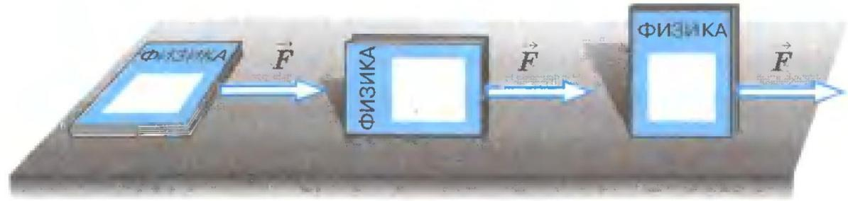
Сила трения — сила, возникающая при соприкосновении поверхностей тел, препятствующая их относительному перемещению, направленная вдоль поверхности соприкосновения.
