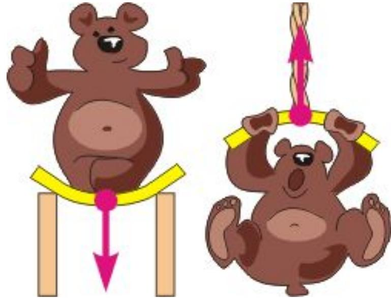
Вес тела — суммарная сила упругости тела, действующая при наличии силы тяжести на все связи (опоры, подвесы).
