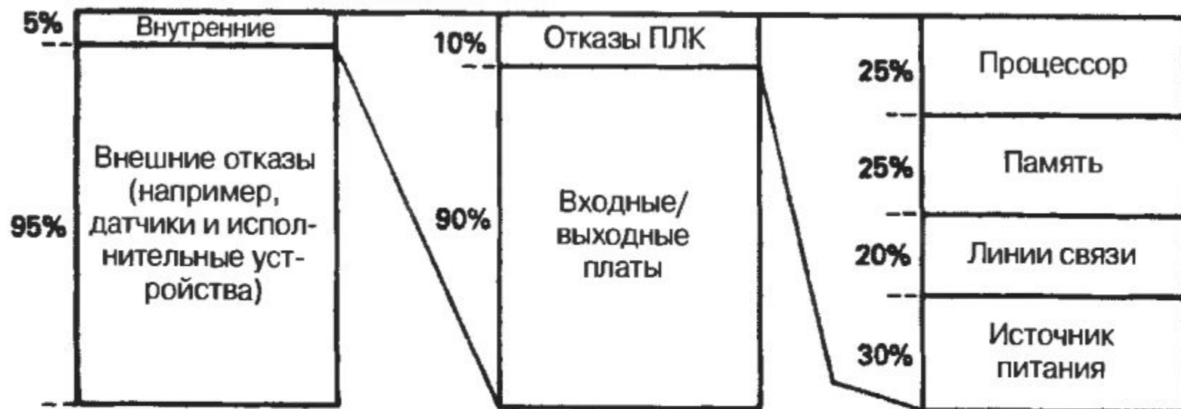
Рис. 8.29. Распределение отказов в типичной системе с ПЛК. Несмотря на то, что только 5% отказов приходится на долю собственно ПЛК, любой отказ в системе, разумеется, регистрируется как «отказ ПЛК»
