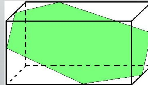
Для построения сечения нужно построить точки пересечения секущей плоскости с ребрами и соединить их отрезками.
