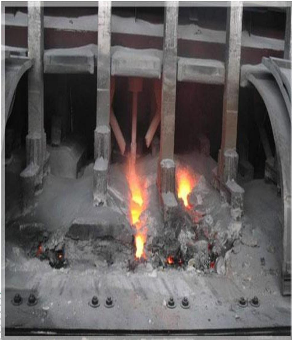
**Современный метод получения заключается в растворении оксида алюминия в расплаве криолита с последующим электролизом с использованием расходуемых коксовых или графитовых электродов.**
