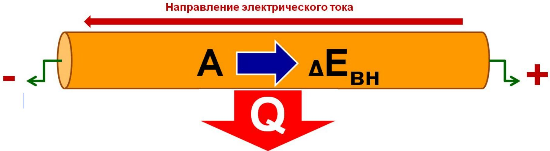
Нагретый проводник отдаёт полученную энергию окружающим телам **путём теплопередачи.**
