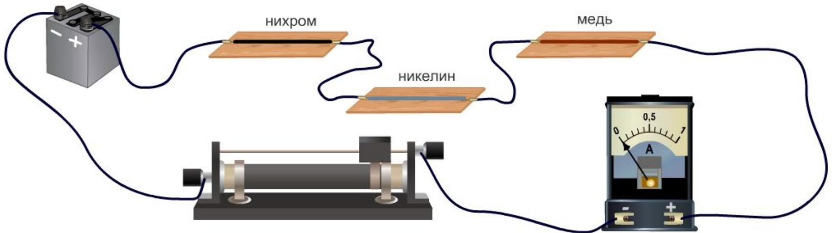
*Количество теплоты, которое выделяется при протекании электрического тока по проводнику, **зависит от силы тока в этом проводнике.***
